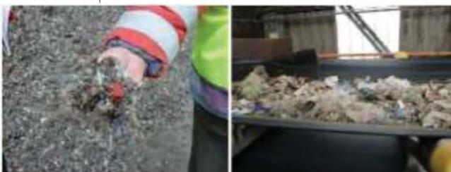
▲ شکل ۱- RDF برای صنعت سیمان (سمت چپ: SRF خوب برای مشعل تصویب شده است، شروط کیفی تولید RDF به شرح ذیل می‌باشد؛ اصلی؛ سمت راست: SRF درشت برای پیش گرمن)
