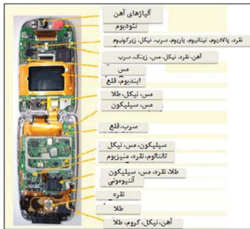
▲ عناصر تشکیل دهنده یک گوشی تلفن همراه
